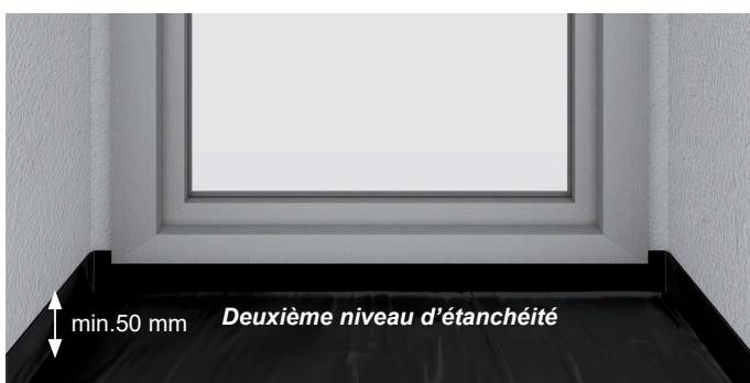
III. 4 : Représentation schématique du second niveau d'étanchéité en forme de cuvette.
