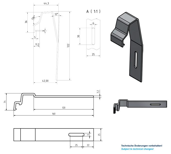
Produktbezeichnung: Halter für Putzfassaden für FBS 40/ Halter für Klinker-/Sichtfassaden für FBS 40 Product designation:
